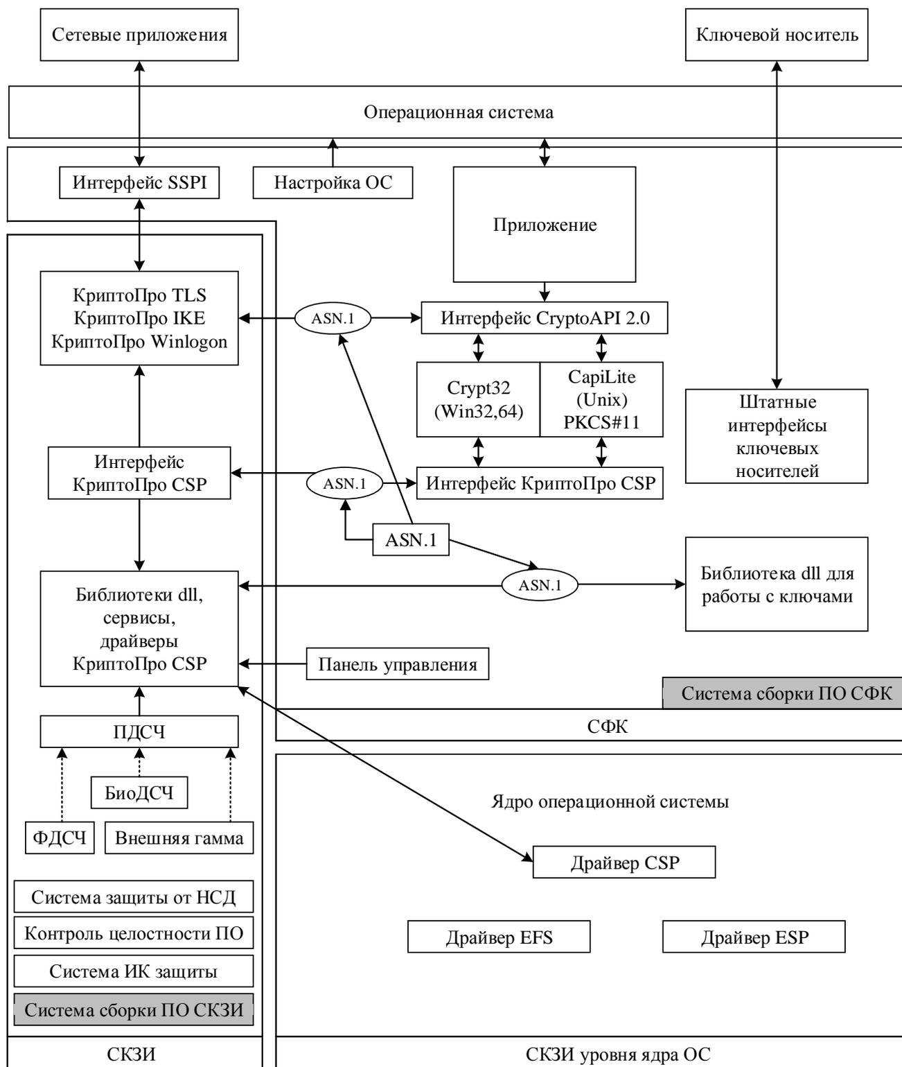
Рисунок 5.1 – Структура СКЗИ «КриптоПро CSP 4.0»
