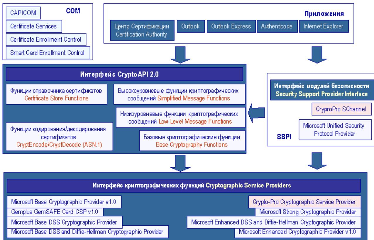
Рисунок 6.1 - Архитектура криптографических функций в ОС Windows
