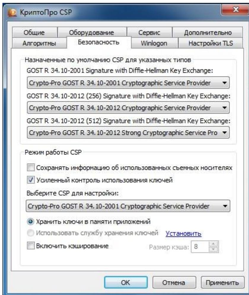
Рисунок 8.1. - Включение режима усиленного контроля использования ключей в контрольной панели КриптоПро CSP.
