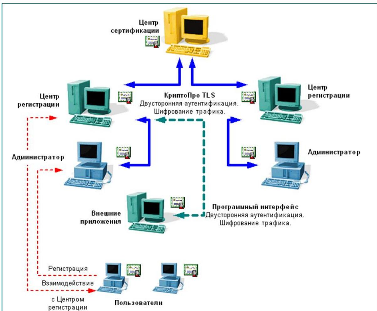
Рисунок Г1 – Схема взаимодействия компонент «КриптоПро УЦ»
