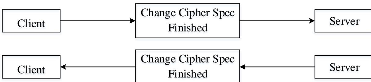
Выбор алгоритмов и параметров для устанавливаемой сессии, завершение Handshake («рукопожатия»).
